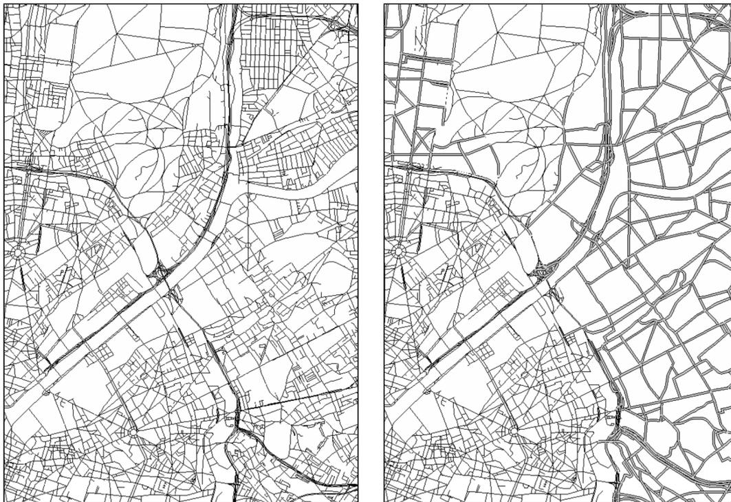
FIG. 2.5 *Différents niveaux de détail. À gauche, une représentation détaillée du réseau routier issue de Géoroute; à droite, on a juxtaposé la même représentation sur Paris et une représentation moins détaillée, celle de la BDCarto, sur la banlieue.*
